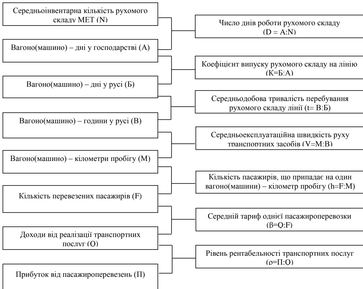
Рис.2. – Аналітико-синтетична схема взаємозв'язку показника прибутку від пасажироперевезень і чинників, що впливають його зміну
